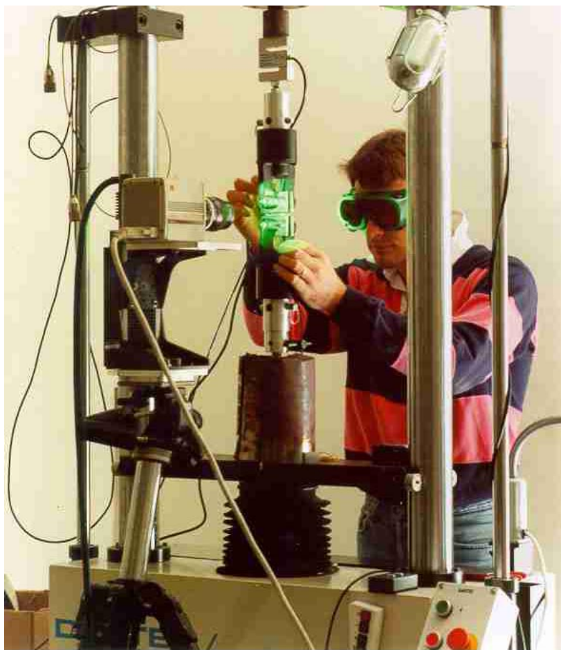
laboratoire de l'école des Mines d'Alès (Extensométrie par photographie numérique de Speckle)
